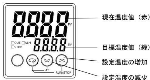
遠隔盤内にある温度調節器で浴槽温度を設定してください。
